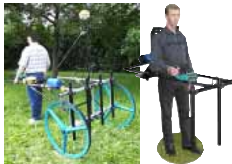
einem Tragegestell oder Leicht-fahrzeug mit Stromversorgung und Positionierungssystem.
