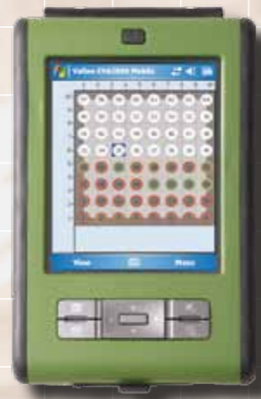
Bohrlochplan auf dem PDA
